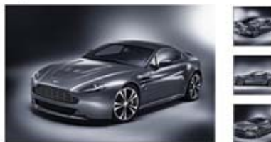
Aston Martin V12 Vantage, prodotta solo in 1000 esemplari. Motore V12 di 6 litri, in grado di raggiungere una potenza massima di 517 CV e una coppia di 570 Nm
